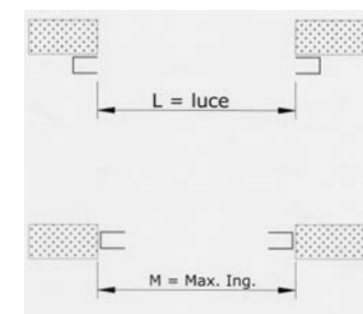
Prospetto per rilievi misure in cantiere
