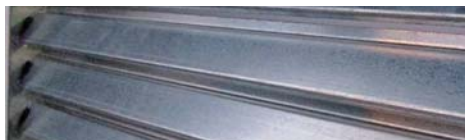
Settore alettato in acciaio zincato. A richiesta verniciatura a polvere RAL. Dimensione variabile in lunghezza - Areazione: cm 2 1860 per metro lineare di griglia (circa 30% della superficie del pannello). Panel galvanized - steel finned section. RAL color coating available upon request. Variable length. Ventilation capability: cm 2 1860 for meter run (the finned section constitutes about 30% of the panel surface).
